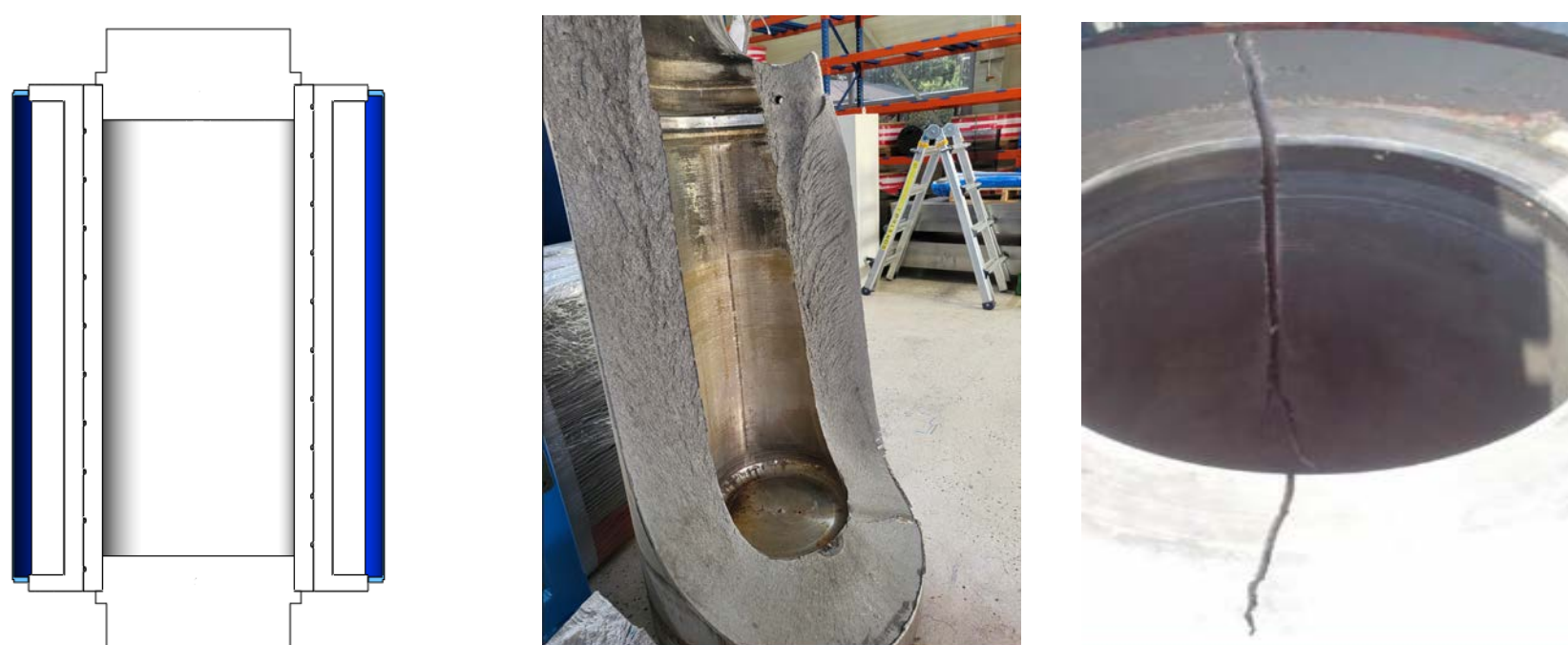
가압 또는 감압의 반복적인 하중으로 인한 피로파괴 발생
